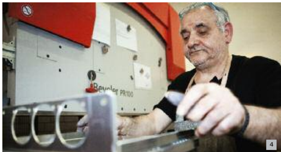
Der Weg des Blechs führt von der Stanz- und der Biegemaschine ...
